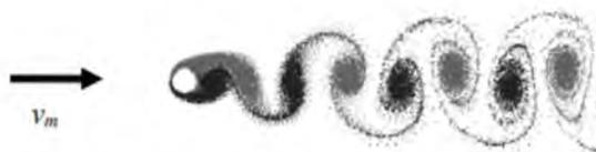
Figura Q.1 – Scia di von Kármán per una sezione circolare.
