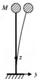
**Figura I.1** – Vibrazioni di una mensola uniforme dotata di massa concentrata all'estremo libero.
