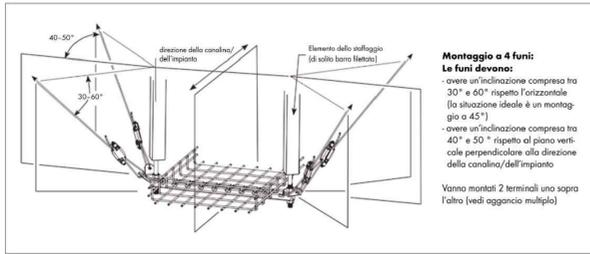
Installare gli staffaggi e relativo Kit sismico ad una interdistanza di 3mt
